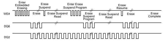
**Note:** The system may use OE# and CE# to toggle DQ2 and DQ6. DQ2 toggles only when read at an address within an erase-suspended sector.
